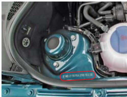
umístění VIN kódů v motorové části
